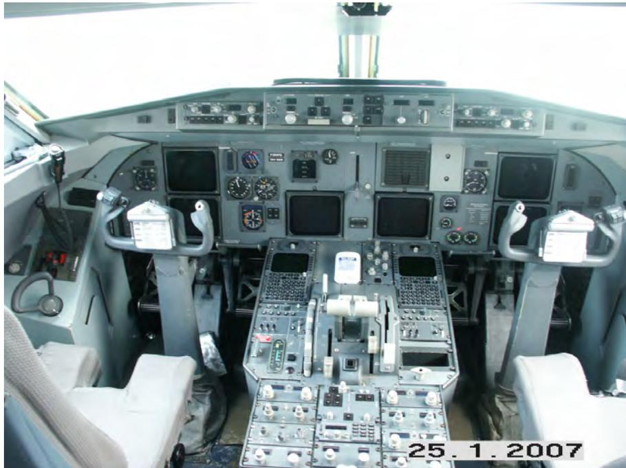
Le pylône central porte principalement les commandes de poussée des réacteurs, de manœuvre des volets, du frein de parc, des destructeurs de portance, du pousseur de manche, le blocage des commandes de vol et la commande secours du train. Il contient également les commandes du Flight Management System, des MFDS et des systèmes de communication et de navigation ainsi que les volants de compensation des ailerons, de la profondeur et de la direction.
